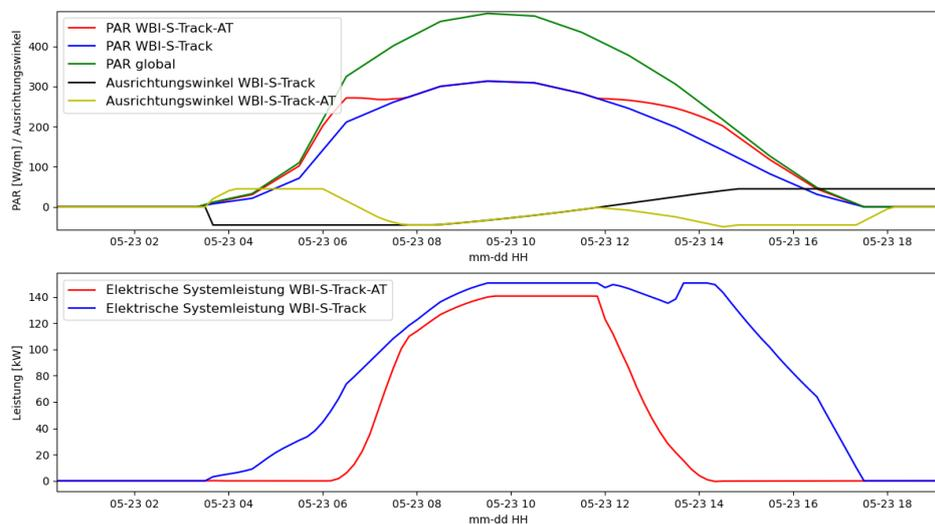
Fig. 33 Oben: Simulierte Ausrichtungswinkel der Varianten "WBI-S-Track-AT" und »WBI-S-Track«, sowie simulierte PAR-Levels auf Pflanzenebene je nach System; Unten: Leistungsverlauf der verschiedenen Systeme.
