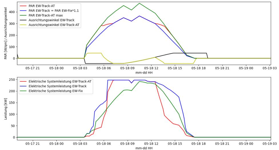
**Fig. 10** Oben: Simulierte Ausrichtungswinkel der Varianten "EW-Track-AT" und »EW-Track«, sowie simulierte PAR-Levels auf Pflanzenebene je nach System; Unten: Leistungsverlauf der verschiedenen Systeme.
