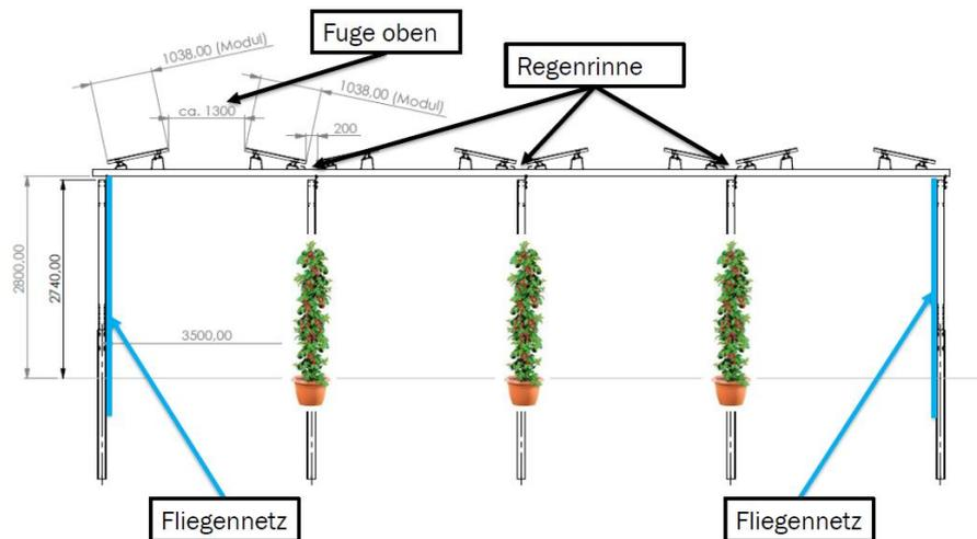
Fig. 14 Skizze des ersten Agri-PV-Entwurfs (Quelle: MKG Göbel).
