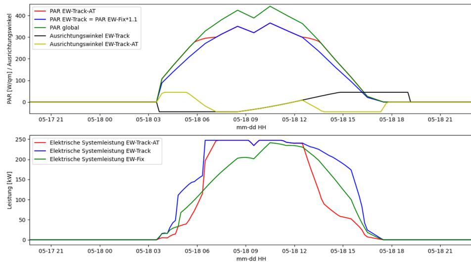
**Fig. 24** Oben: Simulierte Ausrichtungswinkel der Varianten "EW-Track-AT" und »EW-Track«, sowie simulierte PAR-Levels auf Pflanzenebene je nach System; Unten: Leistungsverlauf der verschiedenen Systeme.
