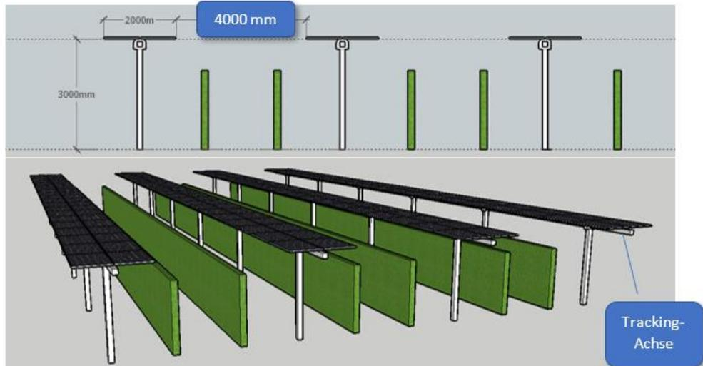
Fig. 32 Illustration des Intech-Reihentrackingsystems für Agri-PV im Weinbau.
