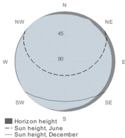
**Fig. 34** Horizontlieniendiagramm für die Flächenoption 2 am Standort Staatsweingut Freiburg.
