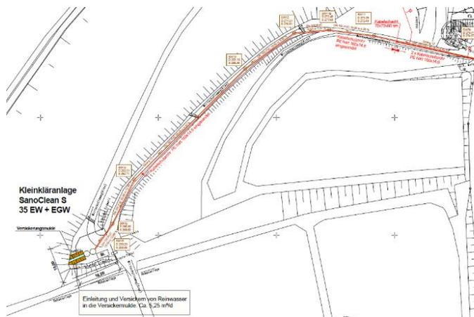
**Fig. 36** Kabelführung zur Kläranlage am Standort Staatsweingut Freiburg.
