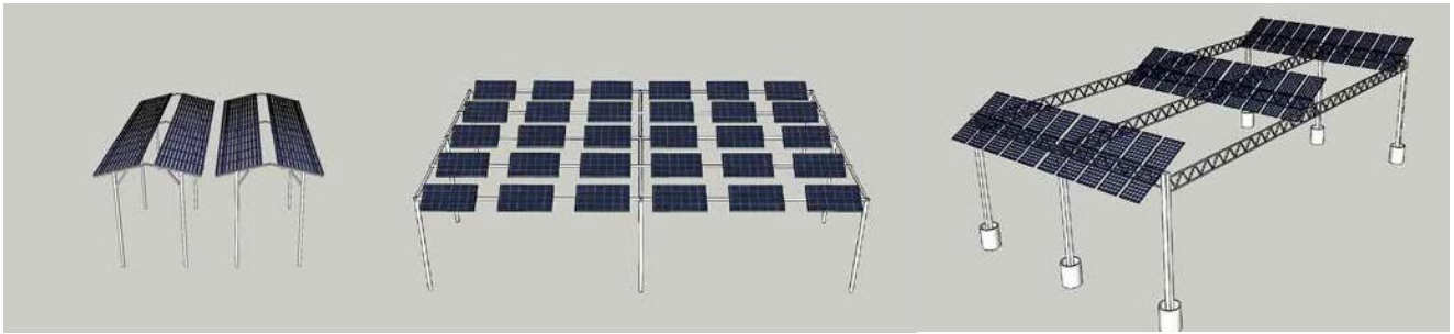
図43: 東西、南、南東の方位を持つ様々なタイプの太陽光発電システムの図解。© Fraunhofer ISE
