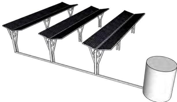
Abb. 64: Konzept einer Regenauffangvorrichtung mit Speichertank © Fraunhofer ISE
